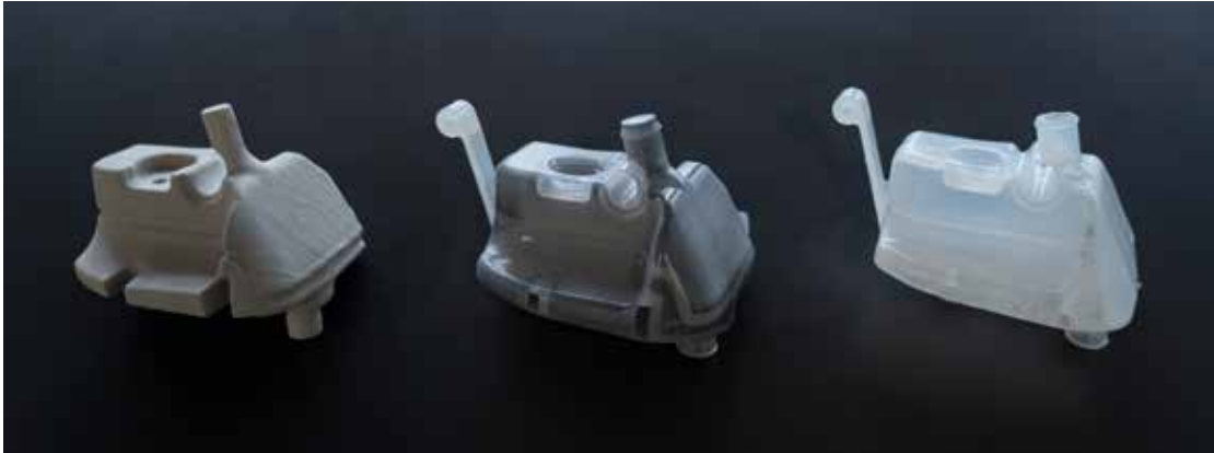
Cavus-Technologie: additiv gefertigter Sandkern (links), Spritzgussteil mit Sandkern (mittig) und Öltank nach dem Auswaschen des Sandkerns.
