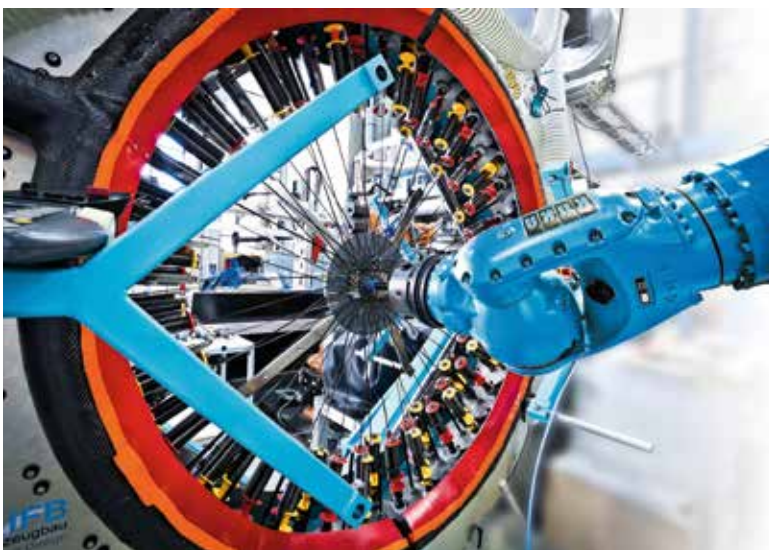
Für die duroplastischen Bauteile wird der hergestellte Kern mit den Carbonfasern umflochten und anschließend im HP-RTM weiterverarbeitet.
