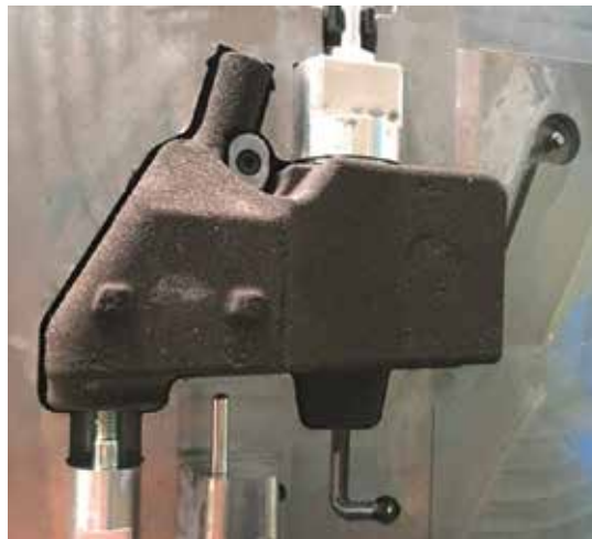
Der Sandkern ist im Spritzgusswerkzeug positioniert.
